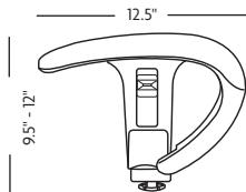
Bras à boucle réglable en hauteur avec coussin de bras en uréthane souple.
