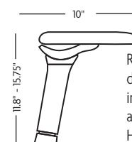
Rotation du coussin et de la base du coussin 360° avec fonction intérieure/extérieure. Glissière avant/arrière la profondeur du coussin. Hauteur réglable.
