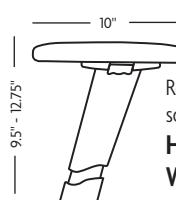
Réglable en hauteur, télescopique, pivotant à 30°
