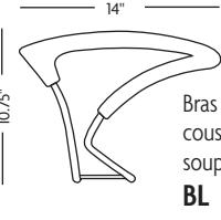
Bras à boucle à hauteur fixe avec coussin de bras en uréthane souple.
