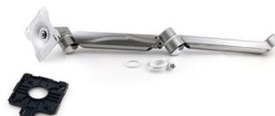
Ensemble avec bras à double extension pour installation sur poteau: Un segment de bras d'extension haute fixe et un à contrepoids réglable en hauteur avec un support de moniteur et montage VESA à connexion rapide.
